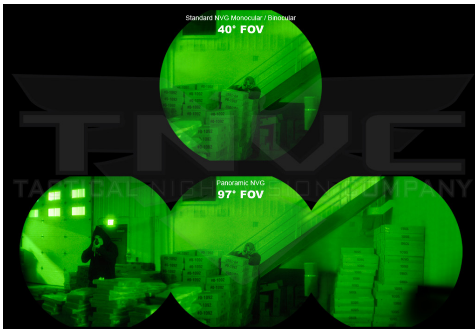
Ryc. 2. Porównanie pola widzenia w goglach dwuokularowych – powyżej oraz w goglach panoramicznych czterookularowych – poniżej
