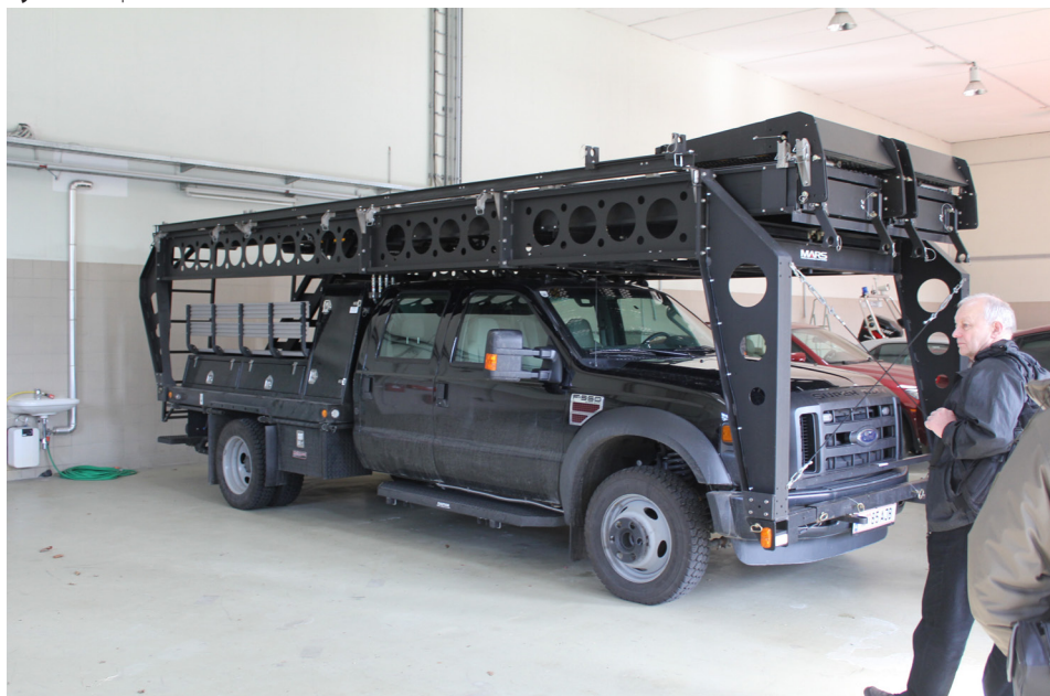
Ryc. 5. Rampa szturmowa MARS
